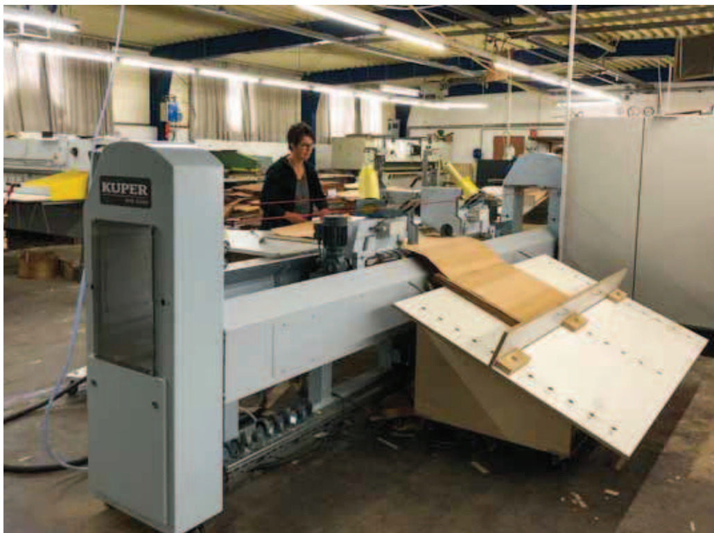
Unverzichtbar für eine professionelle Endkontrolle: Die „EVB“ zum Besäumen und Endverkleben der Furniere
